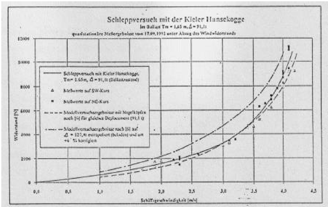
Abb. 3: Der Schiffswiderstand beim Schleppversuch.
